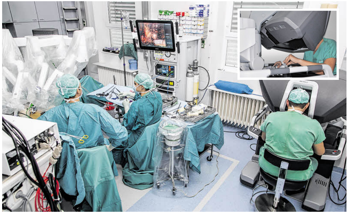
Auf einer Konsole führt der Chirurg Handbewegungen aus (kl. Bild), die auf im Körper des Patienten eingeführte Roboterarme übertragen werden. Das System arbeitet dabei mit höchster Präzision. BILDER: SALK
